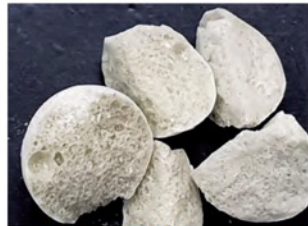
Struktural LiGrA mempunyai pori-pori halus yang dikemas padat
